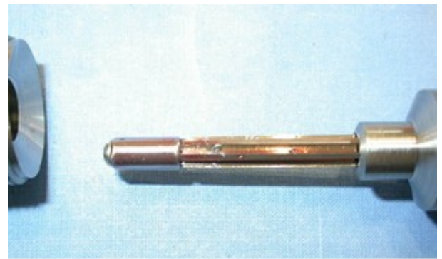
il throater con i trucioli di metallo asportato in rosso si intravede l'olio da taglio per inox
